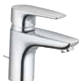
342760575 jednopáková umývadlová batéria DN 15 75 mm pre beztlakový prietokový ohrievač vody s kovovou odpadovou súpravou
