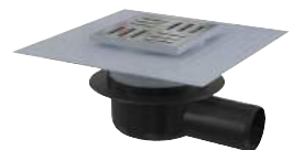
PODLAHOVÁ VPUST Podlahová vpusť 105 x 105/50 boční, mřížka nerez, límeč 2. úrovně izolace, suchá zápachová uzávěra APV26C | 23,04 €
