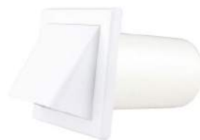
VM 150 x 150 GK/100b Větrací mřížka gravitační – klapka. Je určena pro ukončení kulatého kanálu. Opatřena odjímatelnou stříškou, která poskytuje ochranu vůči dešti a povětrnostním podmínkám. Rozměr (mm): 150 x 150/100
