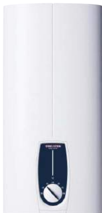
ELEKTRONICKY REGULOVANÝ PRŮTOKOVÝ OHŘÍVAČ DHB-E 18 SLI v/š/h – 478/225/105 mm, bílá barva, elektronicky regulovaný, 18 kW, 400 V 232015 | 564 €
