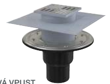
PODLAHOVÁ VPUST Podlahová vpusť 105 x 105/50/75 přímá, mřížka nerez, nerezová příruba a límeč 2. úrovně izolace, vodní a suchá zápachová uzávěra APV4344 | 29,80 €
