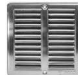
NVM 150 x 150 Větrací mřížka s rámečkem a síťovinou pro vnitřní i venkovní použití s vysokou tuhostí a odolností. Potravinářská nerez DIN 1.4301, kartáčovaný povrch SB 320
